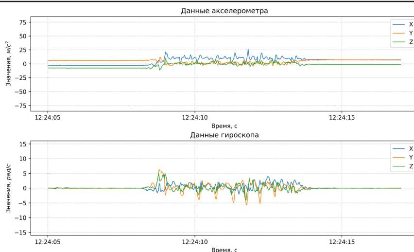
Рисунок 8 – пример данных акселерометрии с определением типа активности собаки (стойка на задних лапах).
